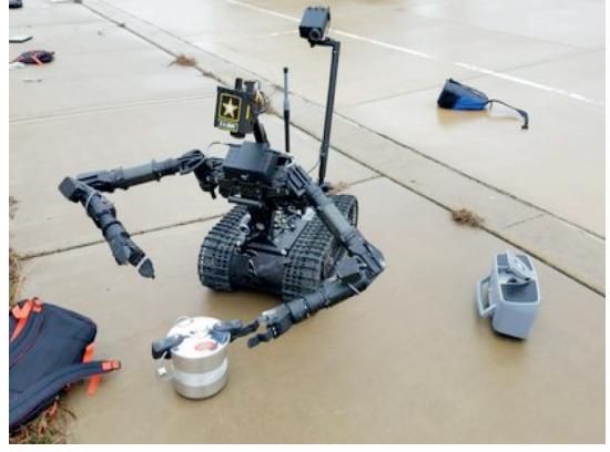
Re2 Robotik Firması "Dexterous Maritime Manipulation System" (DM2S) Sistemi
